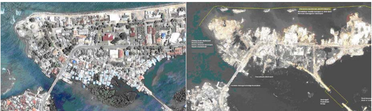
Fotos satelitales que muestran una de las zonas de Banda Aceh antes y después del 26 de diciembre de 2004 ( www.digitalglobe.com ). La destrucción generalizada se debió al ingreso del mar con un tirante de hasta 9 m a velocidades de entrada y retirada de varios metros por segundo
